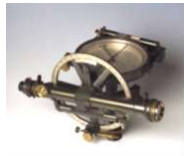
Boussole tranche-montagne De Koningh for triangulation
